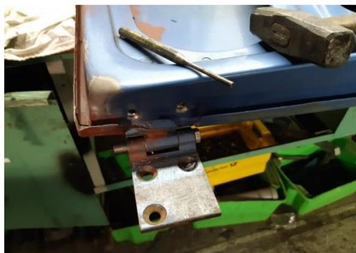
Mit einem Dorn und sanfter Gewalt lassen sich nun die Reste des Niet durchtreiben. Wenn noch Reste vom Nietkopf dran sind klopft man die mit durch/ab. Klappt das noch nicht, noch mal mit dem 7 mm Bohrer nachsetzen
