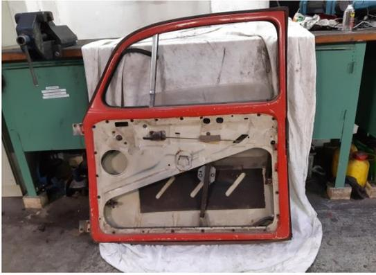
Zum Ausbau der Scharniere muss die Türe von der A-Säule abgeschraubt werden. Nur die Türverkleidung kommt ab. Der Rest bleibt zusammen
