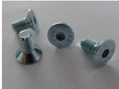
Die Schrauben dienen als Ersatz für die fummeligen Schlitzschrauben. Mit einem flachen Inbus (nicht Kugel) oder Schraubendreher mit Innensechskant-aufsatz einfach einschrauben
