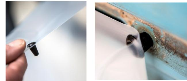
2 Gummitüllen oben durch die Folie stecken und oben leicht in die Tür drücken. Immer erst durch die Folie. Noch nicht komplett eindücken. Nun von oben nach unten immer gegenüberliegend die Tüllen leicht andrücken. Bei der Hälfte die Folie nach oben klappen und z.B. mit einem Magneten hoch halten damit man die Lasche einfädeln kann
